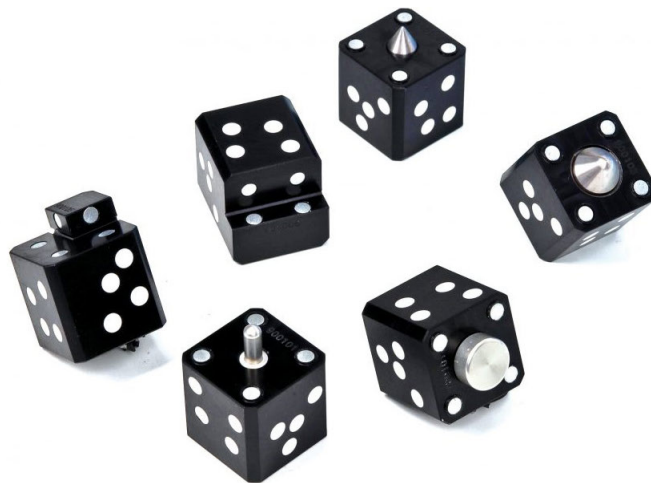
Bild 2. Die Adapter tragen eine codierte Punktmatrix für die Vermessung mit Photogrammetriesystemen. Diese machen optisch nur schwer erfassbare Messpunkte „sichtbar“. © Witte
